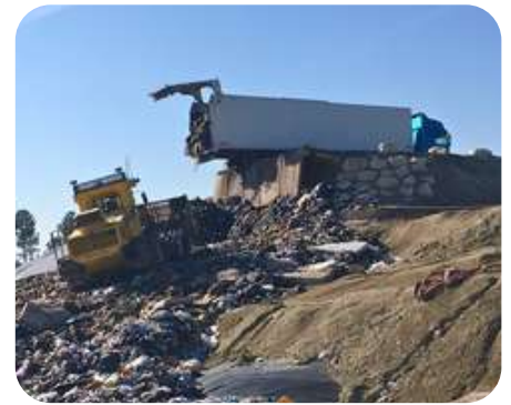
► Un camion FMA transporte de grands volumes de déchets en vrac et les décharge facilement et en sécurité grâce à son fond mouvant hydraulique
