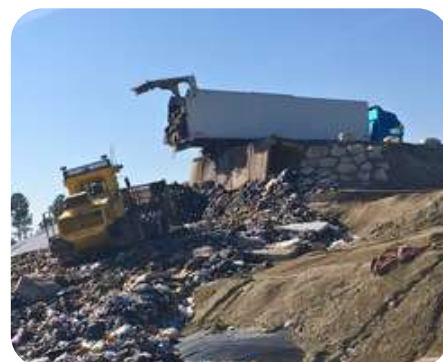
► Un camion FMA transporte de grands volumes de déchets en vrac et les décharge facilement et en sécurité grâce à son fond mouvant hydraulique
